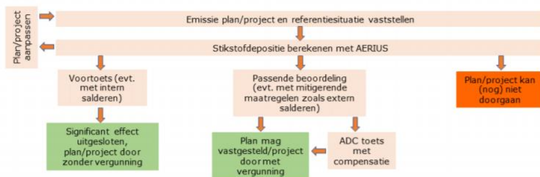
figuur 2: schematische weergave van het stappenplan voor toestemmingverlening stikstofdepositie bij nieuwe activiteiten (Bron: BIJ12, Handreiking Voortoets Stikstof februari 2021).
