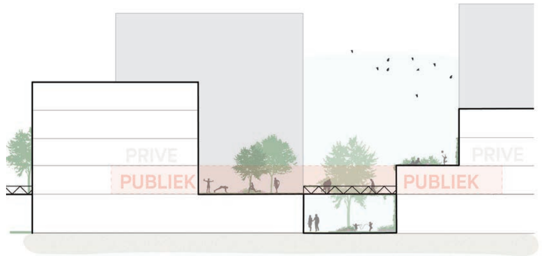
Doorsnede laat de werking van een tweede maaiveld zien in de alledaagse situatie
