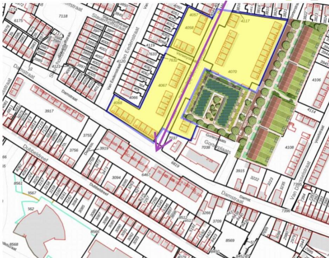
Figuur 25. Het deel van de complexen dat in fase 3.1B gesloopt zal worden. Bron: Trebbe, Faseringsopties Dubbeldam, Dordrecht
