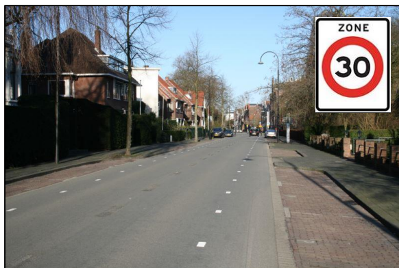
30 km zone: alle verkeer op 1 rijbaan (optische versmalling om de snelheid van het autoverkeer te verlagen)
