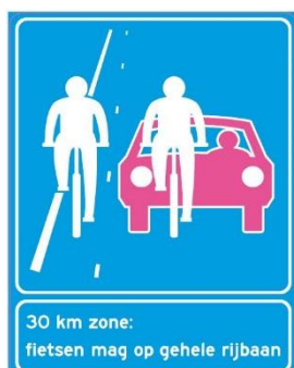
30 km zone: alle verkeer op 1 rijbaan (optische versmalling om de snelheid van het autoverkeer te verlagen)
