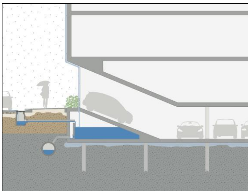
Figuur 6.1 Voorbeeld waterberging in hellingbaan parkeergarage.
