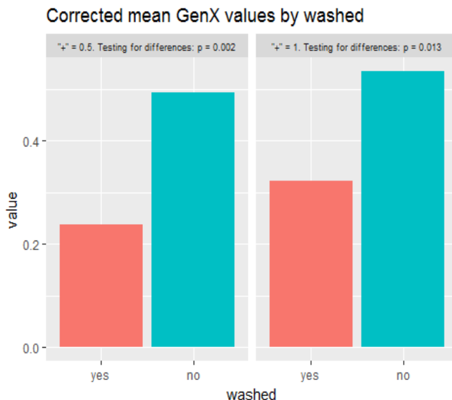
Figuur 4.8. Invloed van wassen op de gemeten GenX concentraties, waarbij de "+" resultaten gelijk zijn gesteld aan 0,5 of 1 ng/g
